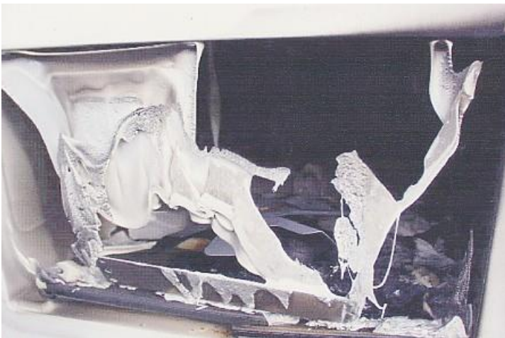
Resultatet efter att säkring utlöst, fläktmotorn stannat och branden slocknat efter ca 30 min. Notera fläkthjulet på microns botten.
