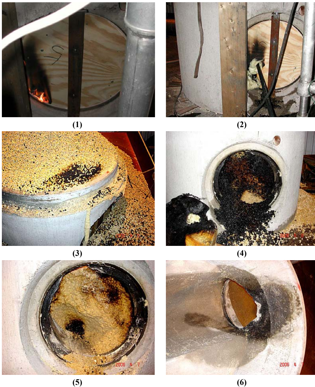
Figur 59 Pyrolys- och brandspridning på grund av otät silokonstruktion i försök 1. Fotona visar: (1) brand på utsidan av täcklucka, (2) vatteninjicering, (3) pyrolyszon efter siloväggen, (4) pyrolyserad pellets innanför täckluckan, (5) liten pyrolyszon längs silobotten på väg mot andra sidan, (6) sotspår på betongen.
