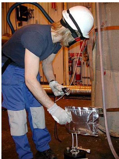
Figur 51 Provtagning av gas genom siloväggen direkt efter vatteninjicering in i pyrolyszonen.
