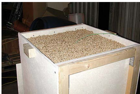
Figur 1 Foto av den låda, (ca 0,5 m x 0,5 m x 1,0 m) som användes vid förförsöken. På bilden har ännu inte locket lagts på plats.
