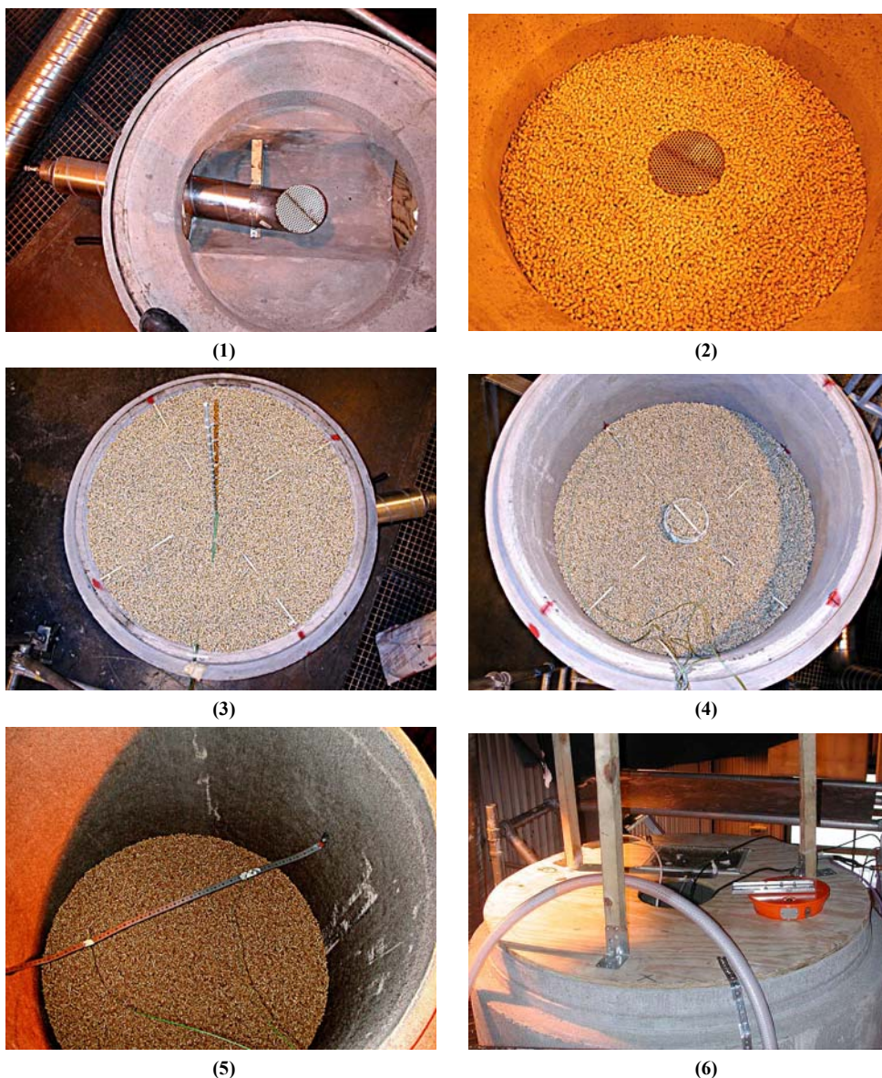
Figur 5 Fotografier av försöksuppställning under pågående montering/fyllning. Som bränsle användes 3,7 m 3 träpellets. Bilderna visar (1) spirokanal för ventilation och inertgasinföring, (2) gasinlopp med bottensektion fylld med pellets, (3) termoelementstapel i centrum och radiellt, (4) tändkälla med radiella termoelement, (5) toppsektionen av silon samt (6) locket på silotoppen med öppning och Firefly MGD branddetektor.
