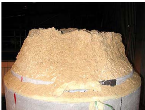
Figur 60 Skumbegjutningen av silotoppen medförde att det översta skiktet av pelletsen svällde och expanderade från 0,1 m till ca 0,3 m.
