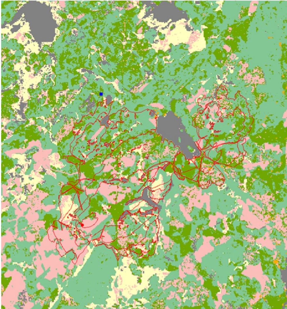
Figur 6. Prometheus-simulering av den första dagens spridning av Sala-branden, när inga begränsningar i form av bevattnade spärrlinjer satts in. De röda linjerna illustrerar brandområdets yttergräns med 2-timmars intervall.
