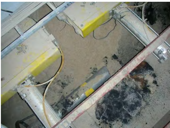
Figur 8 – Bild från tömning där kalla glödrester syns.
