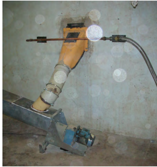
Figur 6 – lansarna samt monterad skruv och alternativ transportör
