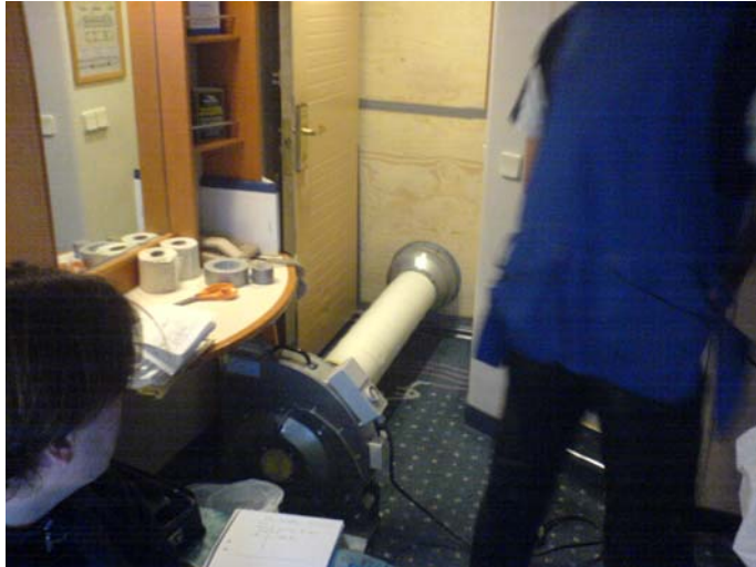
Figur 4.1 Trycksättande fläkt applicerad i dörröppning till fartygshytt.
